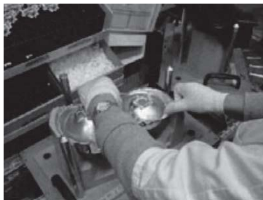
Algunas piezas (como los reflectores de un faro de coche) deben ser manipulados con guantes.
