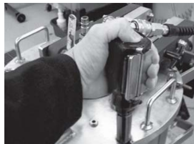
Herramienta mecánica para comprobar las tapas de unos tanques de acero.
