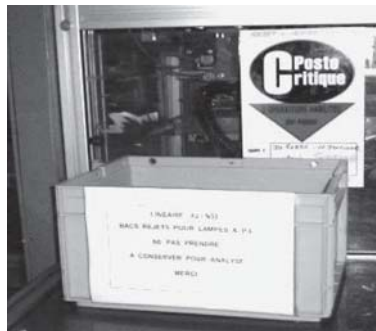
Piezas rechazadas en un contenedor verde, hay riesgo de que sean mezcladas con unidades buenas.
