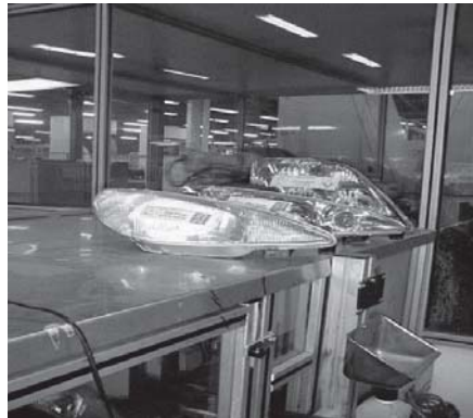
Dos piezas “diferentes” con el riesgo de ser mezcladas con el producto que se fabrica.
