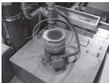
Un filtro excesivamente sucio calentará el motor y le hará perder eficacia.
