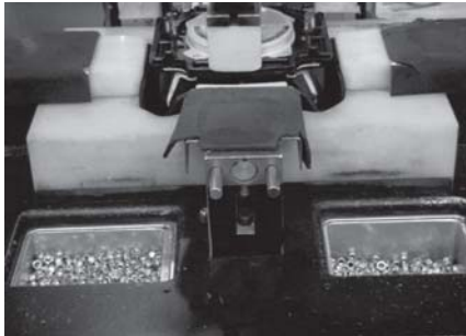
Las tapas se abren cuando la pieza llega a la estación de trabajo y está colocada en su posición.
